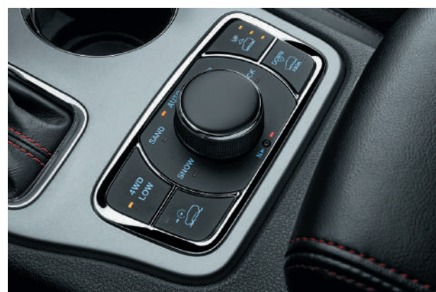
СЕЛЕКТОР SELEC-TERRAIN™ С СИСТЕМАМИ ПОМОЩИ ПРИ СПУСКЕ (HDC) И ПОМОЩИ ПРИ СТАРТЕ НА ПОДЪЕМЕ (HSA)
